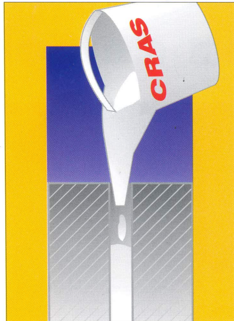
fig 2. Sistema ideal para la correcta carga de agujeros horizontales
